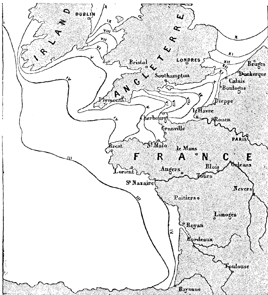
Fig. 9. — Marche successive de la marée pour les différents ports avec fureur une nappe d'eau qui a parfois plusieurs mètres de hauteur et qui endommage toutes les constructions des rives
