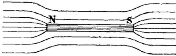
FIG. 47. — Flux d'induction.
