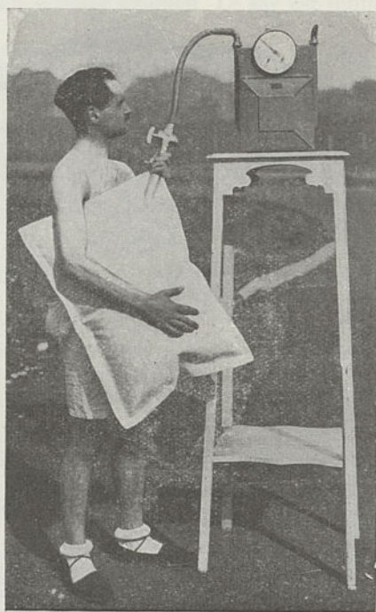
FIG. 142. — Evaluation à l'aide d'un compteur spirométrique de la quantité d'air total contenu dans le sac où un prélèvement de 100 cmc. d'air aux fins d'analyse, a déjà été fait.
