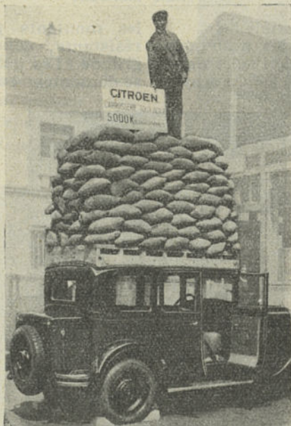
Une expérience qui a été bien souvent renouvelée aux Usines Citroën; Carrosserie tout-acier chargée de 5 tonnes sur son pavillon. C'est le poids de 75 à 80 personnes
