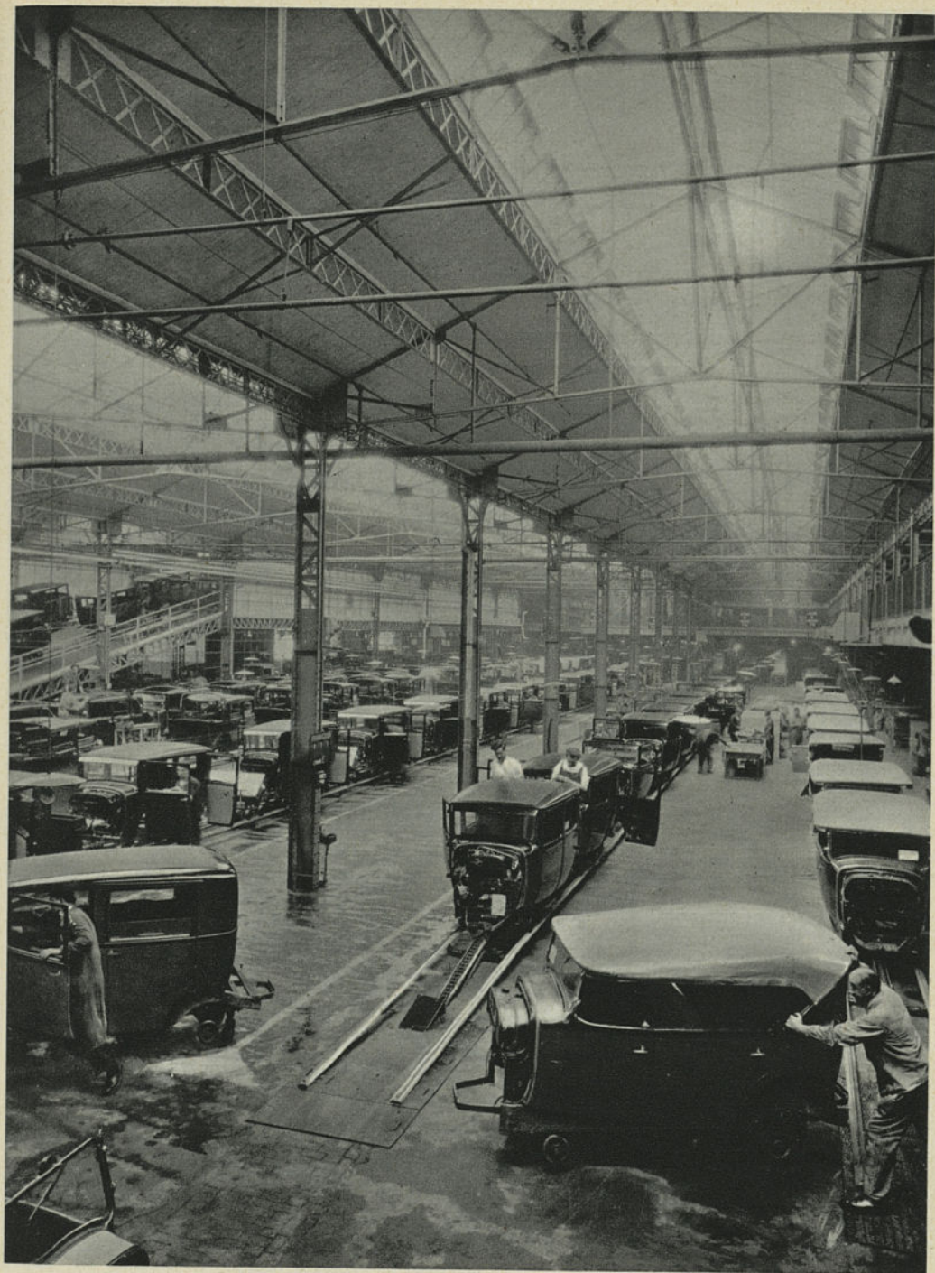
Usine Citroën de Javel. L'atelier de finition des carrosseries, où les caisses reçoivent leurs pavillons, leurs garnitures et leurs glaces.
