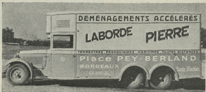
Un camion de déménagement sur châssis Citroën 6 roues.
