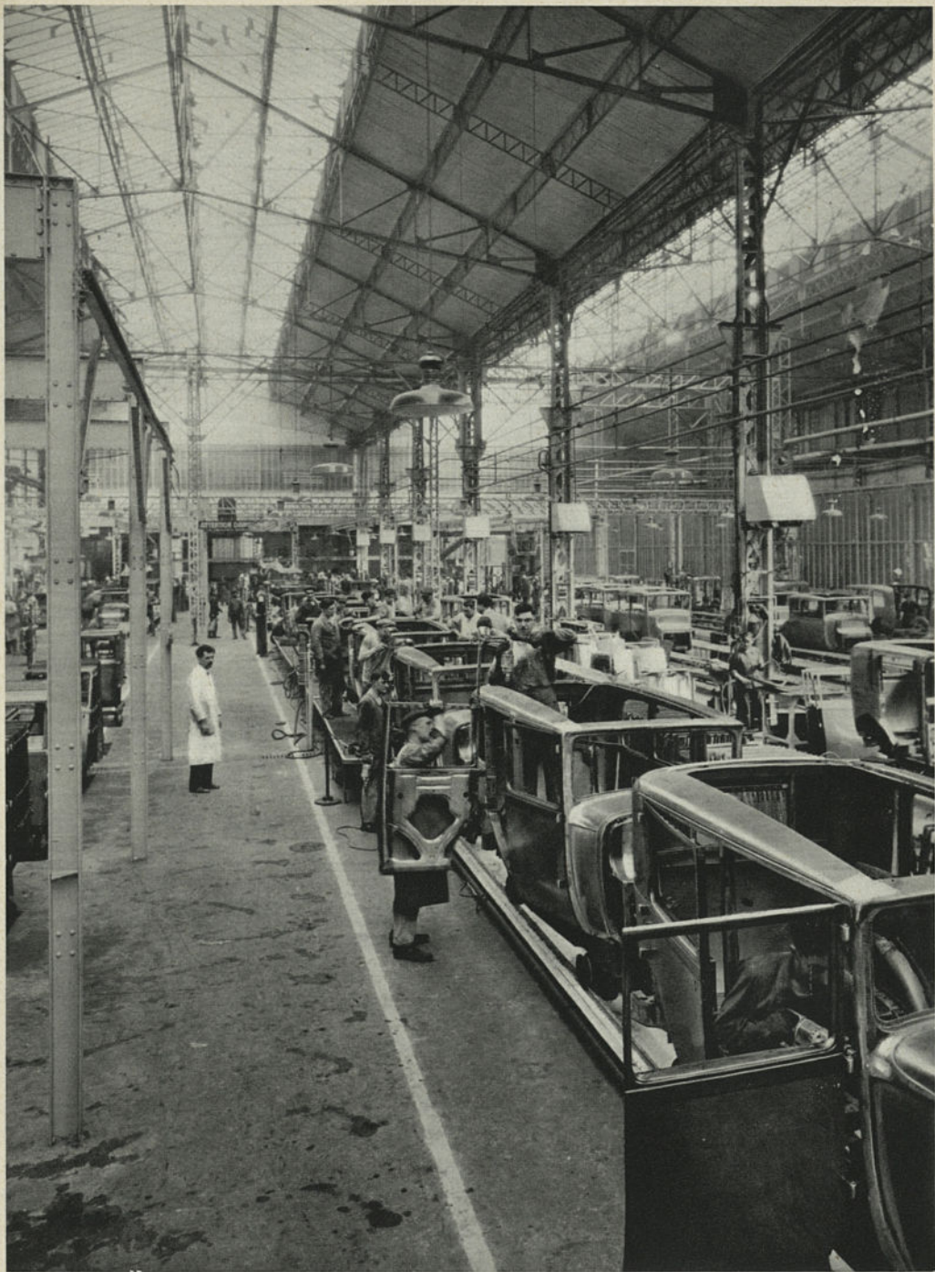
Usine Citroën de Javel. Sur la chaîne de « ferrage », après assemblage des éléments de la carrosserie tout-acier par soudure électrique ou autogène, les portes sont mises en place et réglées.
