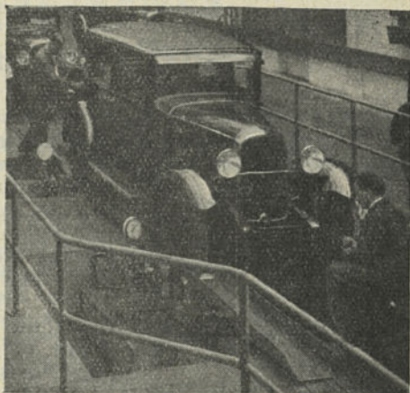
Usine de Javel. Contrôle et réglage des freins à la sortie de la chaîne de finition des voitures.
