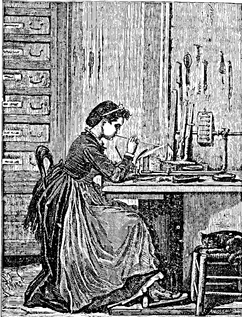
Fig. 97. — Ouvrière parisienne soufflant une fausse perle.
