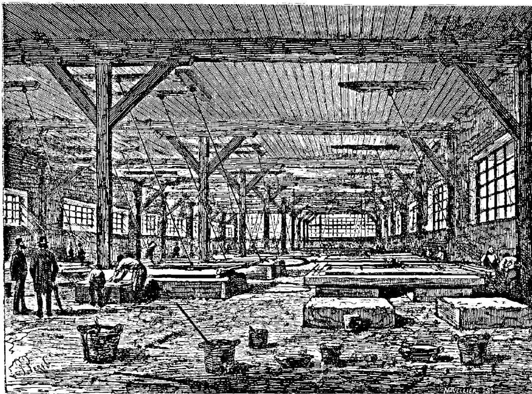
Fig. 51. — Opération du doucissage des glaces.
