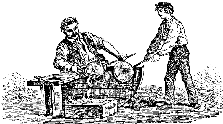
Fig. 82. — L'ouvrier rogne, avec des ciseaux, la base du verre à pied.
