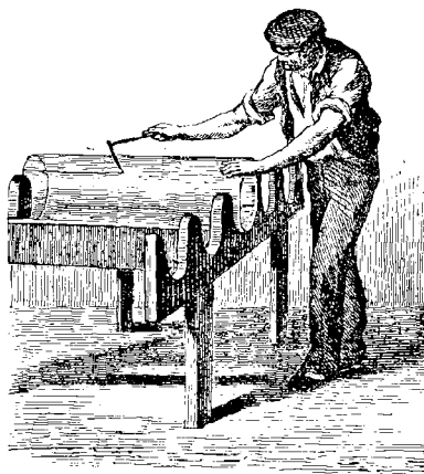
Fig. 27. — Ouvrier fendant le manchon.
