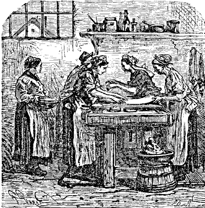
Fig. 52. — Argenture d'une glace par le procédé Drayton.
