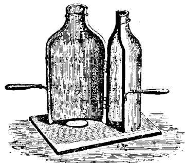
Fig. 70. — Moule d'un flacon de cristal.
