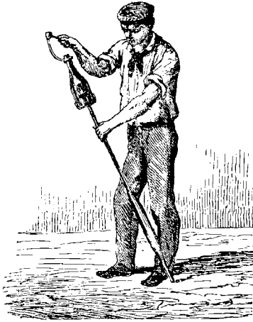
Fig. 39. — Façonnage du goulot de la bouteille.
