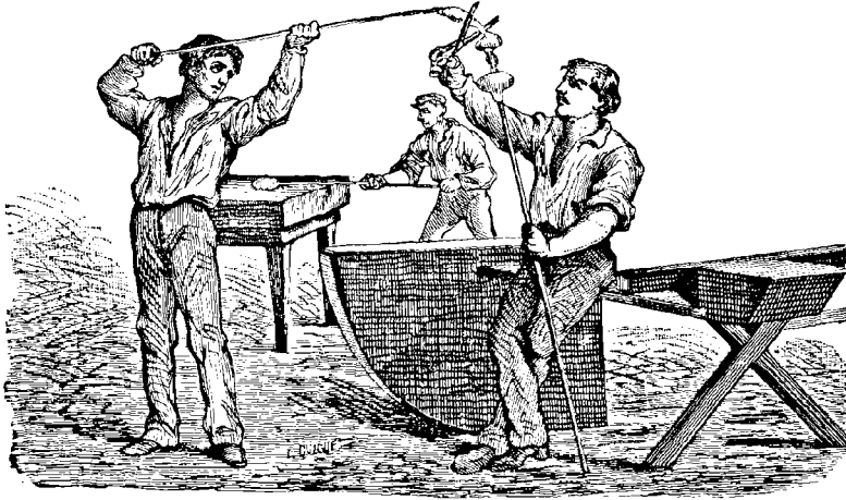
Fig. 78. — Pose de la matière du pied du verre.
