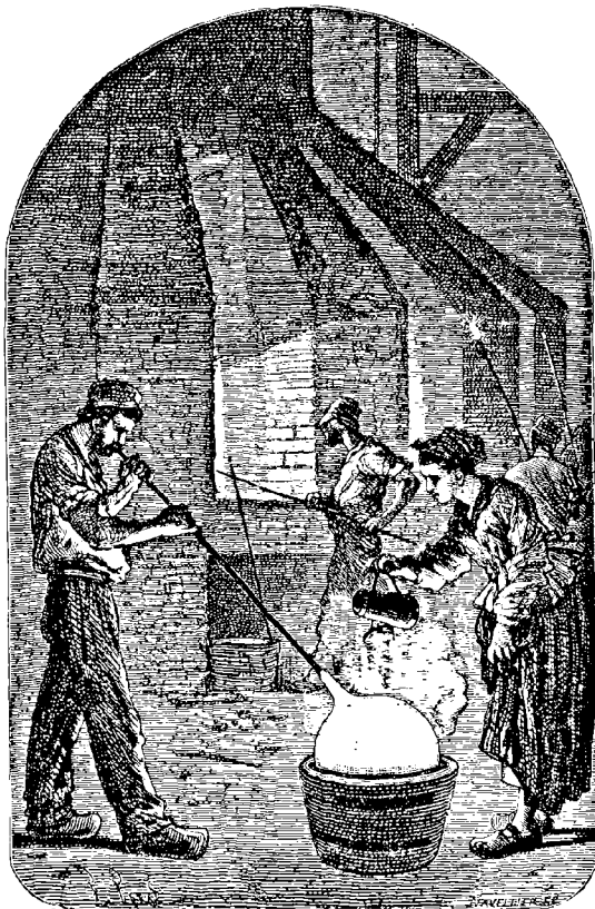
Fig. 43. — Soufflage d'une bonbonne.
