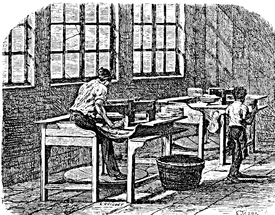
Fig. 267. — Gabarit pour la fabrication des assiettes.
