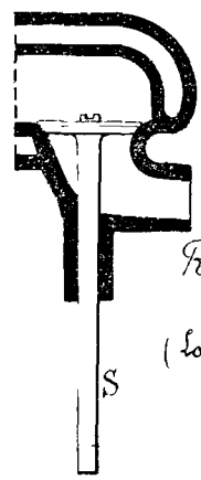
Fig. 54 Régulation sur l'échappement
