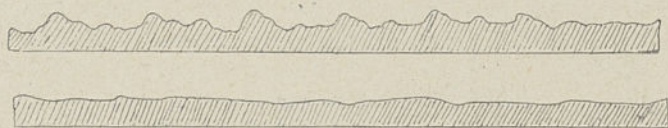
Fig. 553. — Surfaces représentant le travail dépensé dans la traction d'une voiture avec un trait rigide A et avec un trait élastique B.
