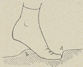
Fig. 334. — Écrasement du sol sous la poussée du pied dans la marche: a , excavation produite; b , soulèvement consécutif.
