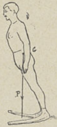
Fig. 120 — Station inclinée obtenue en donnant aux semelles une grande longueur et une grande rigidité.
