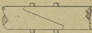
Fig. 374. — Enture à « trait de Jupiter », pour assemblage de pièces en prolongement l'une de l'autre.
