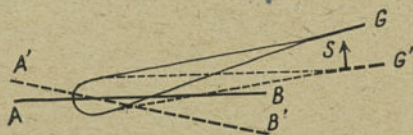
Fig. 215. — Equilibreur G, ou queue stabilisatrice, assurant la stabilité longitudinale, c'est-à-dire rattrapant les perturbations accidentelles d'équilibre en mouvement horizontal.
