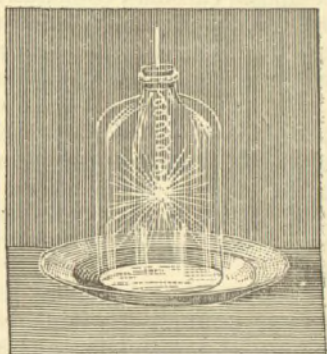
Fig. 5. — Combustion du fer dans l'oxygène.
