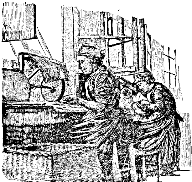
FIG. 75. — Polissage de l'argent. Ateliers de Christoffe et C ie .
