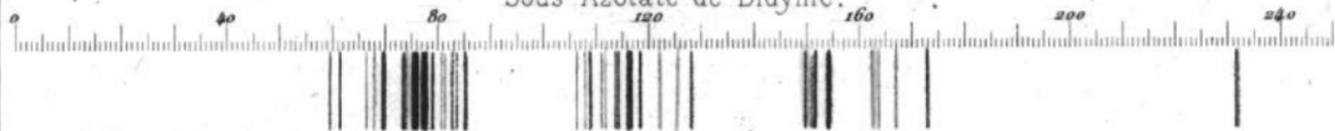
Calcination du Sous azotate dans l'Hydrogène.  $X_1$
