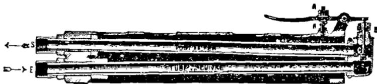
Fig. 138. — Purgeur Geipel à dilatation.
