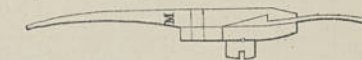
Fig. B. Disposition des aiguilles pour le tricot simple ou mi tubulaire.
