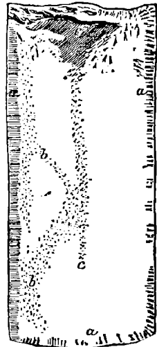
Fig. 204. — Section verticale d'un lingot d'acier fondu.
