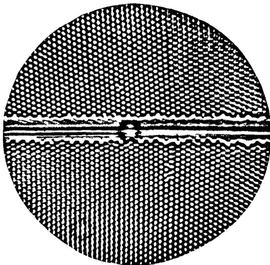
séparées; en le remplaçant par un objectif de pouvoir séparateur moindre on obtient la seconde image (*fig. 45*), où ces taches lumineuses forment une série de lignes continues.
