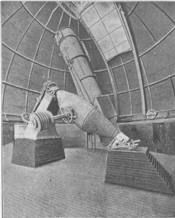
Le télescope Crossley et sa nouvelle monture.
