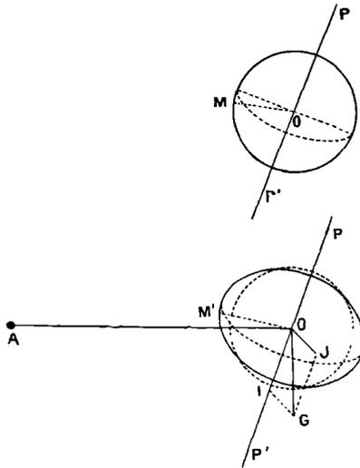
même vitesse angulaire par rapport à un axe  $PP'$  (*fig. 91*), de sorte qu'elle tourne comme un solide; cette masse prend la forme sphéroïdale et elle est en équilibre dynamique sous l'action de l'attraction mutuelle des molécules et de la force centrifuge.
