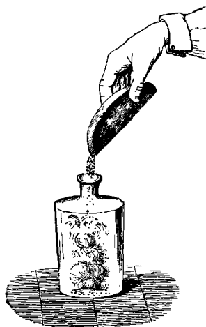
Fig. 59. Combustion directe de l'antimoine dans le chlore.
