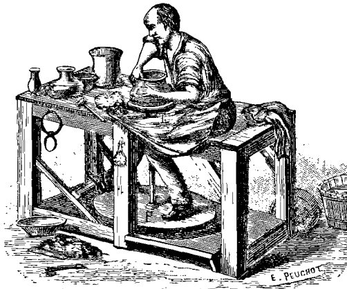
Fig. 210. — Tournassage des poteries à la main sur la roue à potier.
