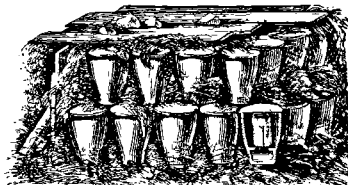
Fig. 227. — Détail des assises des pots à céruse.
