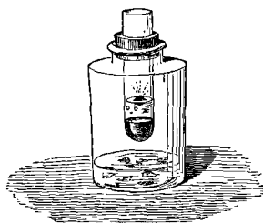
Fig. 116. — Charbon incandescent nageant sur le protoxyde d'azote liquéfié au-dessous duquel est du mercure solidifié par le froid produit par volatilisation de Az^2O .
