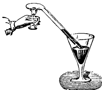
Fig. 141. — Combinaison du cyanogène au potassium.
