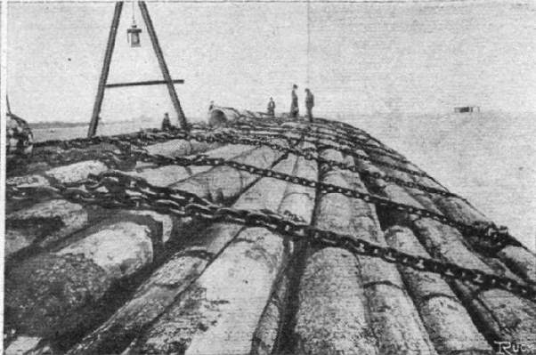
LA RECONSTRUCTION DE SAN-FRANCISCO.— Radeau de bois, long de 200 m., avec un chargement de 4 millions de pieds cubiques de cèdre, et arrivant en vue de la Porte d'Or, à San-Francisco, remorqué par un vapeur. Le radeau n'avait pas encore franchi la passe que des enchères s'improvisaient sur le quai.
