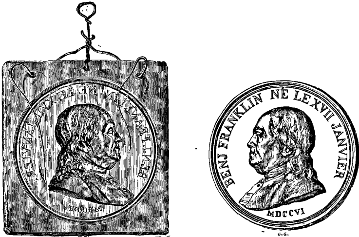
FIG. 416. — Reproduction d'une médaille par la galvanoplastie : moule en creux et médaille reproduite en relief.
