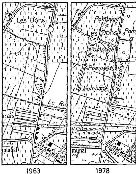
Fig. 9. — Comparaison d'extraits des cartes topographiques de 1963 et 1978 montrant la disparition des immeubles après la mise en service des pompages.
