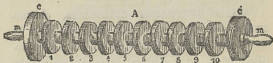
Fig. 8. — Rouleau pour impression multicolore.
