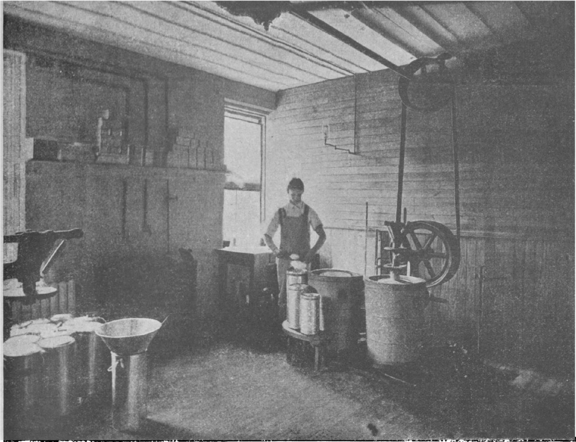
FIG. 398. — Sortie de la crème du réfrigérant. — IXL Ice Cream Co. ( Ice and Refrigeration , t. XXVII, n° 5, novembre 1904.)
