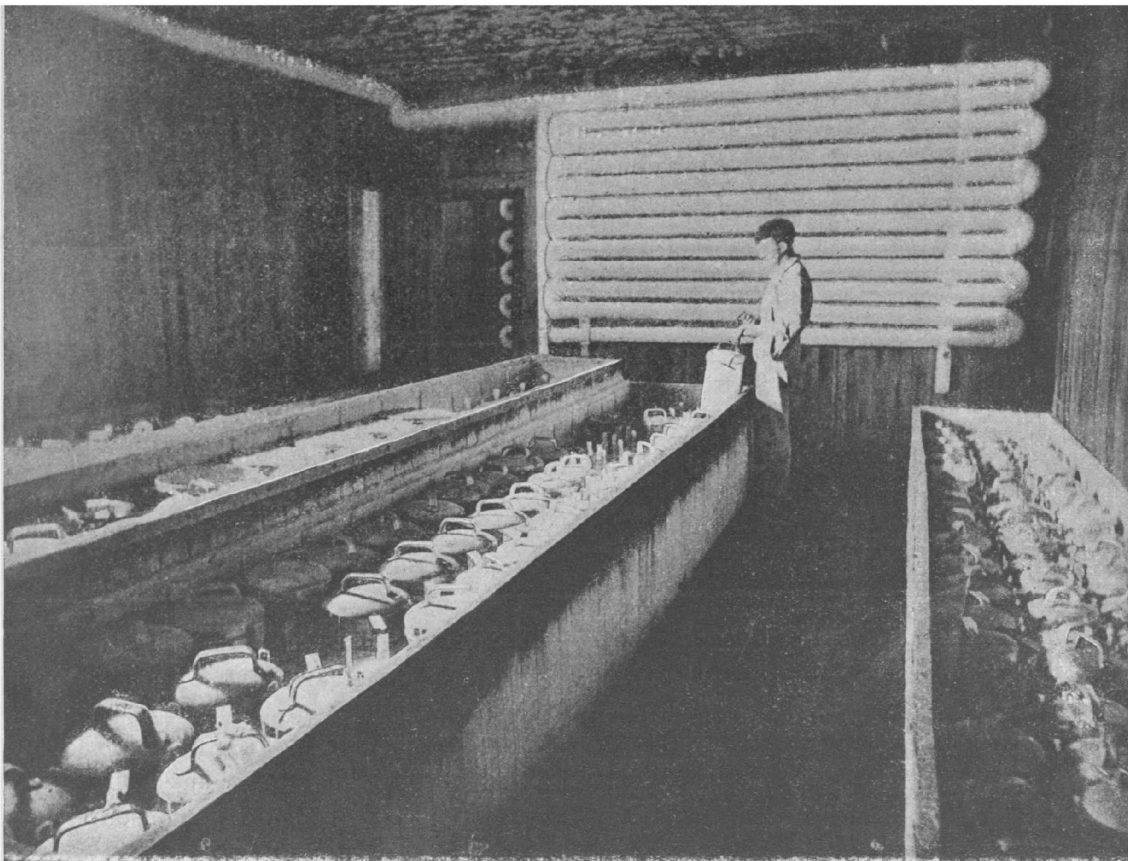
FIG. 399. — Bac de solidification pour la crème congelée. — IXL Ice Cream Co. ( Ice and Refrigeration , t. XXVII, n° 5, novembre 1904.)
