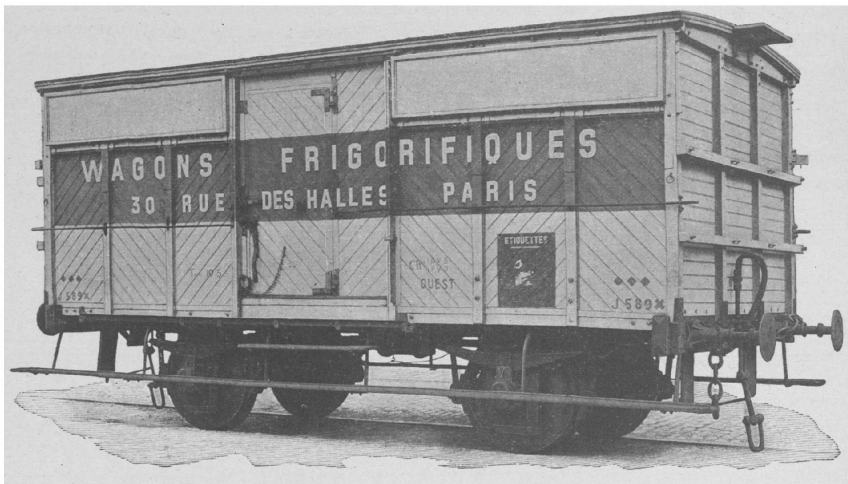
FIG. 259. — Wagon-glacière de la Société des wagons et entrepôts frigorifiques de France (Wagon de l'Ouest aménagé).
