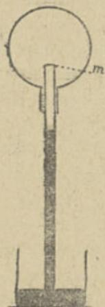
Fig. 49. — Tube fermé par une membrane végétale *m*, et surmonté d'un ballon.
