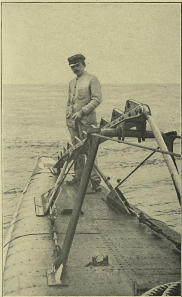
POUR FRANCHIR LES FILETS Appareil fixé à l'avant des sous-marins allemands pour couper les mailles des filets de barrage.
