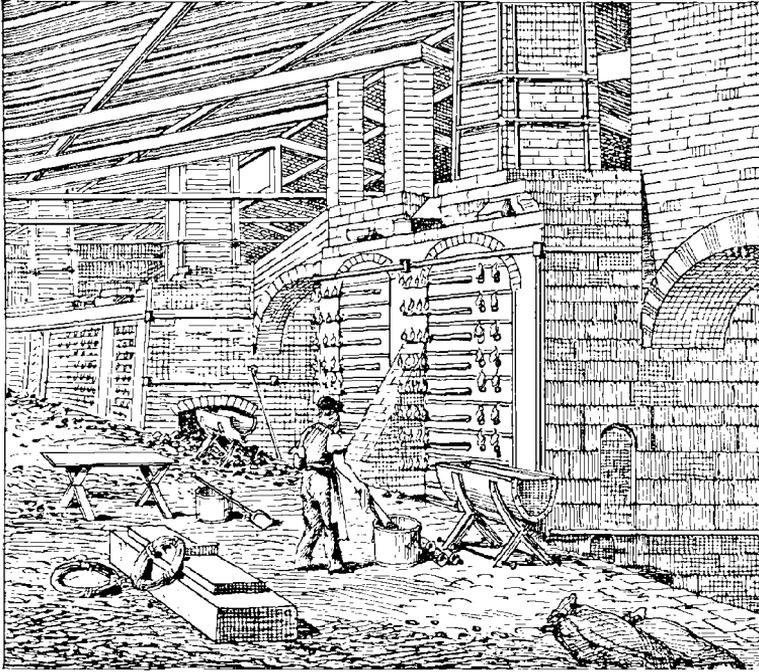
FIG. 43. — Aspect extérieur d'un four belge pendant l'opération.
