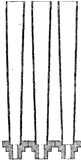
Fig. 35. — Coupe verticale des tubes du four carinthien, d'après Karsten. — Échelle : 0,05.
