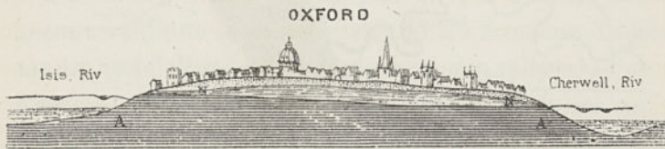
Fig. 21. — Coupes du sol de la ville d'Oxford, montrant la disposition de la nappe phréatique N N, dans le gravier que supporte l'argile A, dite d'Oxford.
