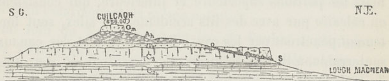
Fig. 155. — Section par Cuilcagh, comté de Fermanagh, montrant la disposition d'un courant souterrain à travers le calcaire carbonifère supérieur, qui alimente, entre autres sources considérables, celle qui jaillit en S, au pied de l'escarpement du Marble Arch. C 2 , calcaire carbonifère moyen; C 3 , calcaire carbonifère supérieur; G 1 , grès et argile de Yoredale; A 1 , schiste de Yoredale; G 2 , millstonegritt; O, orifice supérieur du conduit souterrain. — D'après la très obligeante communication de M. Edward Hull.
