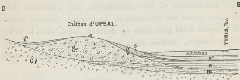
Fig. 44. — Disposition de la source jaillissant au-dessus du château d'Upsal. Gr, granite; m, ancienne moraine de fond; g, gravier (Os); a, argile glaciaire; g', sable; a', argile post-glaciaire; S, source. Échelle \frac{1}{7.500}
