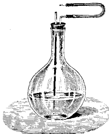
Fig. 163. Appareil pour le dosage du glucose par fermentation.
