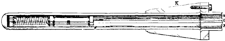
Fig. 26. Pyromètre électrique de Siemens (portion du tube en fer contenant le fil de platine).
