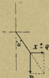
Fig. 272. — Décomposition des forces dans une caténaire souple.
