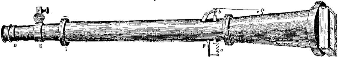
Fig. 103. — Chambre noire télescopique du Photo-héliographe
