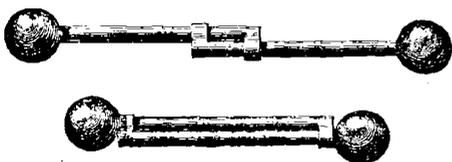
Fig. 242 et 243. — Boulets réunis par un axe.
