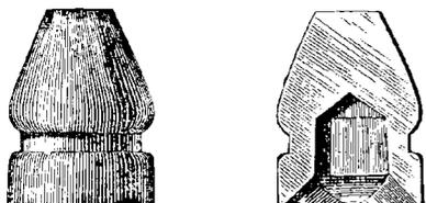
Fig. 362 et 363. — Balle modèle 1863 et coupe verticale de cette balle.
