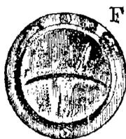
Fig. 92. — Disque de verre dépoli éclairé par l'objectif.
