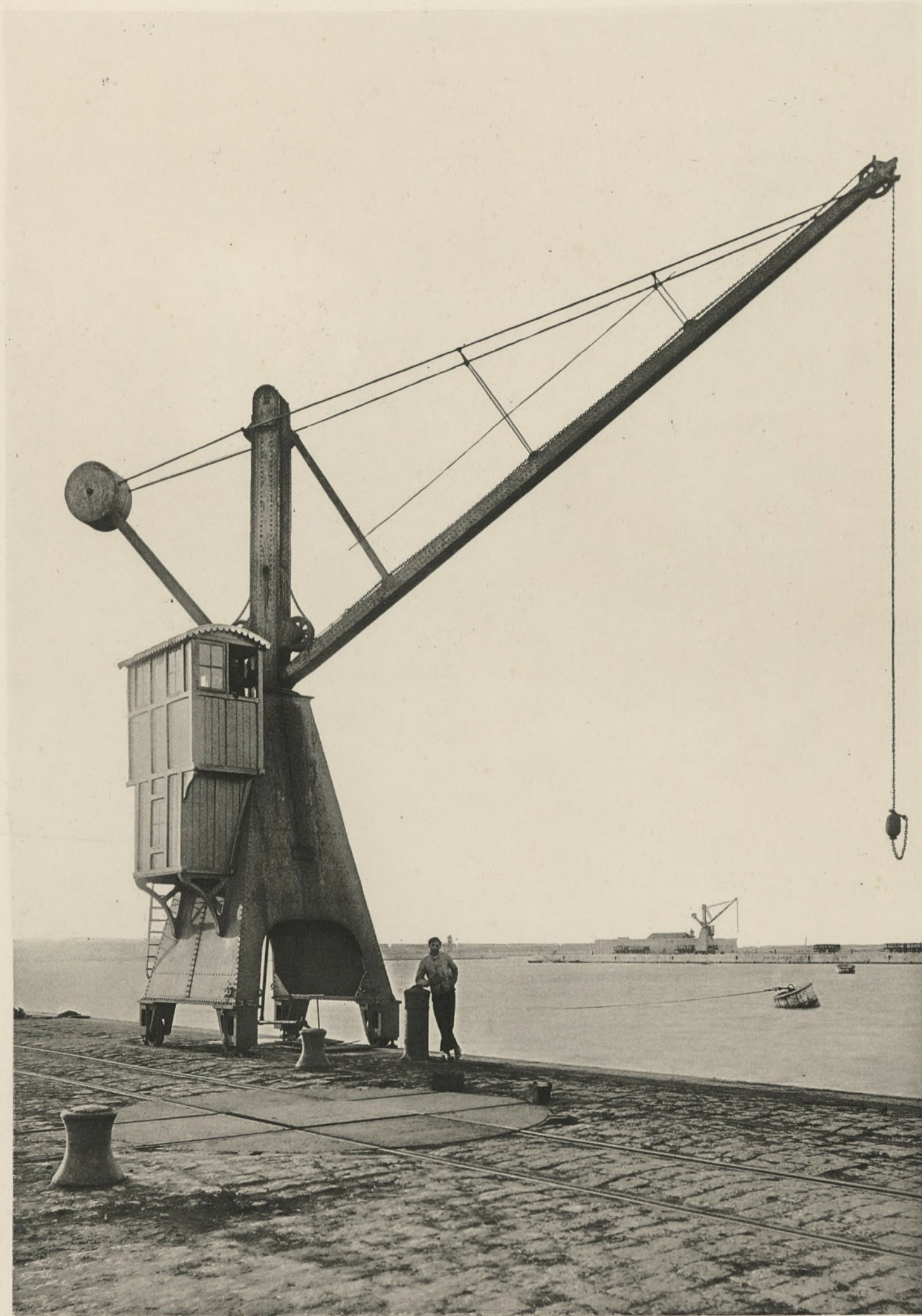
GRUE HYDRAULIQUE MOBILE POUVANT ENLEVER 1250 K OS Port de Marseille - Outillage hydraulique de la Chambre de Commerce
