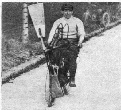
M. ARCHDEACON a établi une motocyclette mue par une hélice aérienne; au cours d'une expérience cette motocyclette, montée par Auzain, a atteint en un kilomètre la vitesse de 79 kil. 506 à l'heure (12 septembre). On espère arriver encore à de meilleurs résultats.
