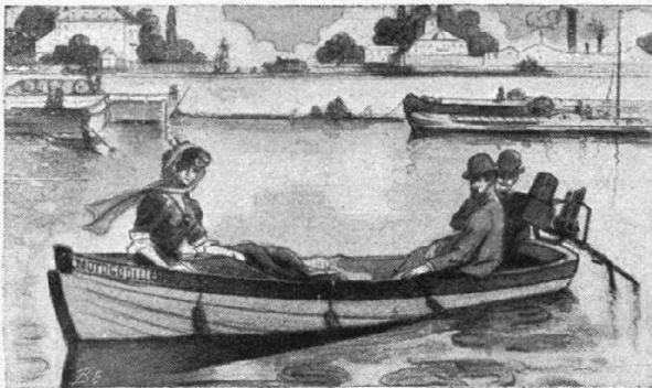
LA MOTOGODILLE. — La motogodille est un petit propulseur à hélice qui s'applique très aisément aux canots et les transforme en « autocanots » sans modification aucune dans leur structure. La motogodille comprend un petit moteur à pétrole qui actionne une véritable petite hélice. Le tout pèse 40 kilogrammes.
