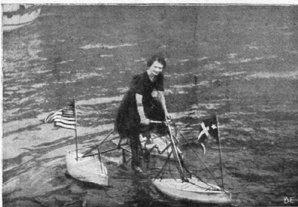
TRICYCLE NAUTIQUE. — Une actrice new-yorkaise, miss Jennie Cannar, a expérimenté avec succès un cycle nautique, monté sur trois batelets formant bouées, qui a fourni une vitesse de 9 kilom. à l'heure.
