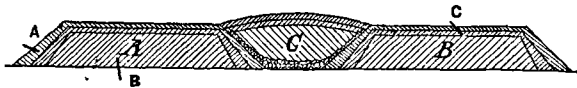
Fig. 5. — Disposition d'un tas de grillage en V (méthode de Peters et Mc. Arthur ).
