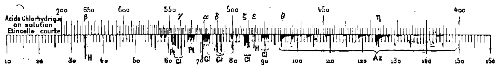
Fig. 111. — Spectre de l'étincelle courte éclatant sur l'acide chlorhydrique concentré.
