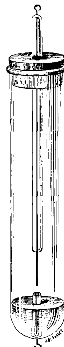
Fig. 107. — Appareil à étincelles (fulgurateur), de MM. Delachanal et Mermet.
