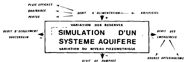
Fig. 2. — Les éléments dynamiques d'un système aquifère. On notera, à la différence des éléments statiques (fig. 1), que chacun des éléments dynamiques est variable dans le temps. La recherche de l'équilibre d'un système aquifère conduit à proposer des caractéristiques dynamiques intrinsèques.
