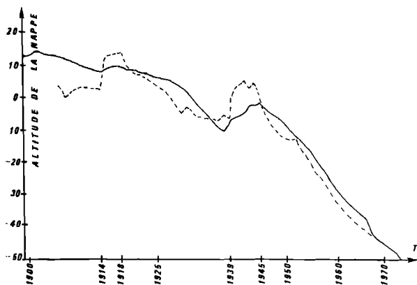
Fig. 74. — Exemple de comparaison interannuelle des évolutions piézométriques calculées (en trait plein) et observées (en traits discontinus) à Roubaix (calcaire carbonifère). Remarque : altitude de la nappe exprimée en m NGF. (Mania, Bull. B.R.G.M., 1976, p. 55).
