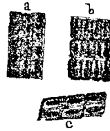
Fig. 56. — Le même lignite soumis à 20 000 atmosphères de pression. Même signification de lettres. — D'après M. Gumbel.
