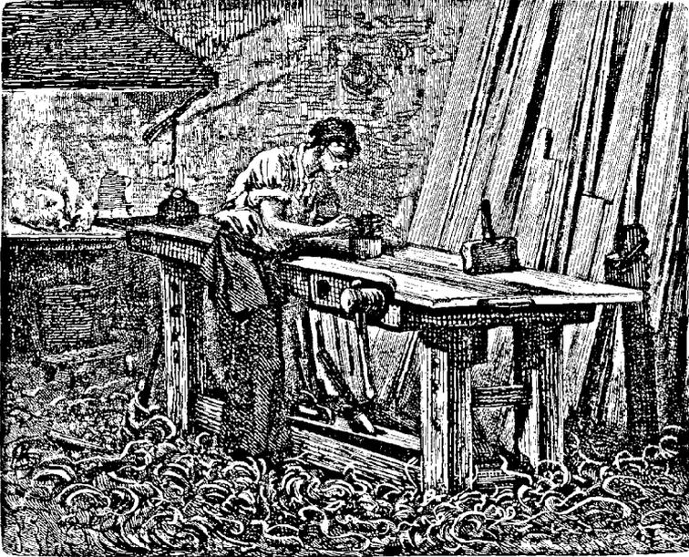
FIG. 353. — Placage au marteau.
