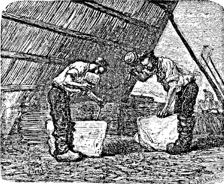
FIG. 25. — Repartonnage et taille de l'ardoise.
