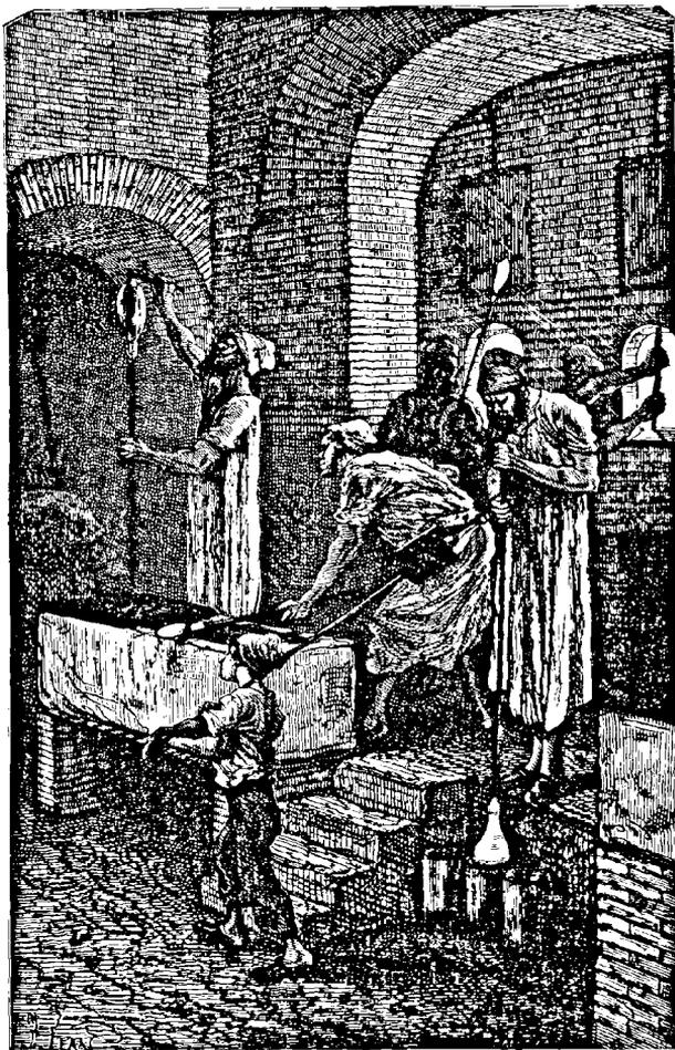
FIG. 374. — Soufflage des bouteilles.
