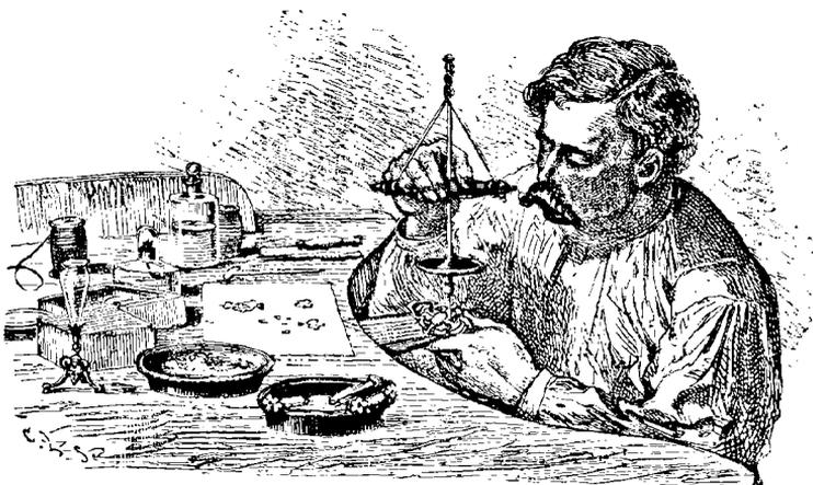
FIG. 322. — Ouvrier bijoutier manœuvrant la drille.
