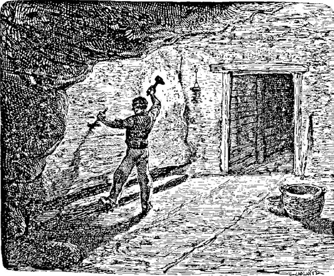
FIG. 15. — Abatage par rigoles et à la poudre.
