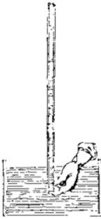
de mercure, puis qu'on le renverse de manière à amener en haut l'extrémité fermée du tube, en bouchant avec le doigt l'extrémité ouverte. Que l'on introduise ensuite l'extrémité inférieure dans une cuvette également remplie de mercure, et que l'on enlève alors le doigt afin de rendre la liberté à la colonne contenue dans le tube.
