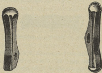
Fig. 95. — Marteaux à emboutir à un bout et à deux bouts.
