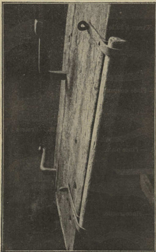
Fig. 217. — Rouleau en bois. Remarquer sur la figure : à gauche, une boule relevée; à droite, une bigorne relevée.
