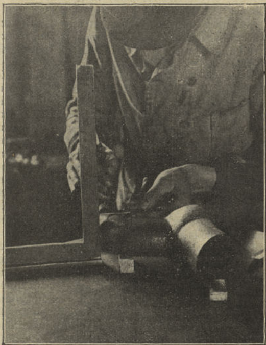
Fig. 264. — Tracé sur le marbre d'une partie de fourches à trois orifices.
