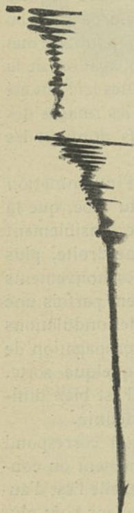
FIG. 31. — Même expérience que dans la figure précédente, mais avec un tube de 10 millimètres. La flamme s'éteint avant d'avoir parcouru le premier tronçon de 1 mètre.
