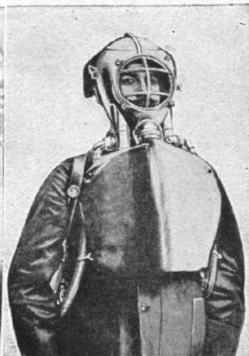
APPAREIL RESPIRATOIRE DE SAUVETAGE. — M. Guglielminetti-Draeger a inventé un appareil respiratoire, à régénération d'air, en usage aux sapeurs-pompiers de Paris et qui permet de pénétrer dans un milieu irrespirable.
