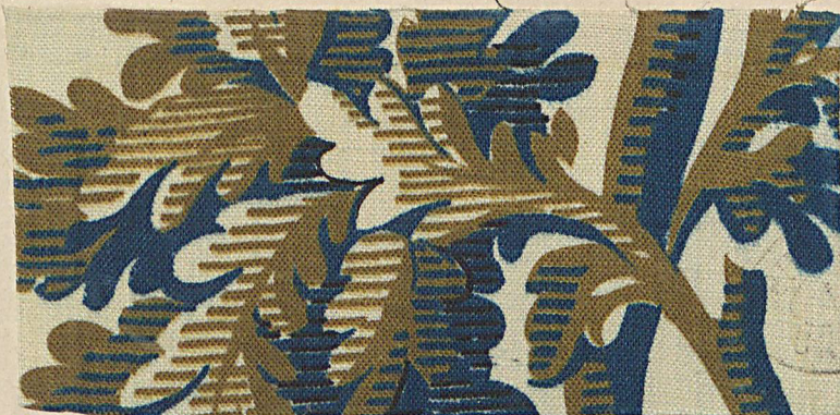
N° 12. — Impression vert moyen (bleu prussiate et chrome, vert Havra-neck). — Besselièvre, fils, à Rouen. — Dérivé du précédent.
