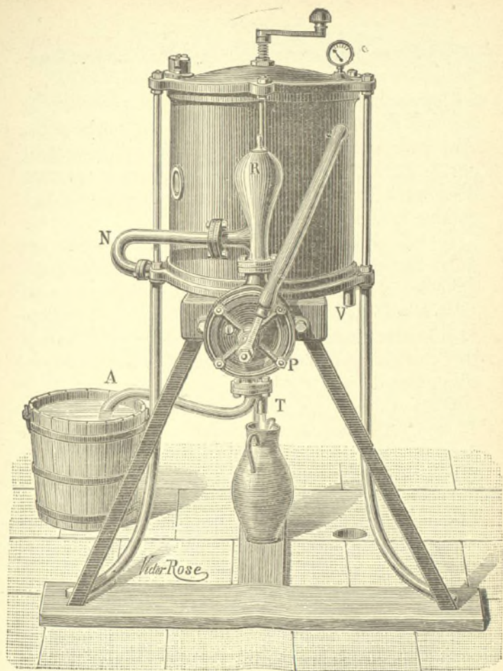
Fig. 44. — Filtre Chamberland, système Pasteur à nettoyeur mécanique O. André, et muni d'une pompe aspirante et foulante.
