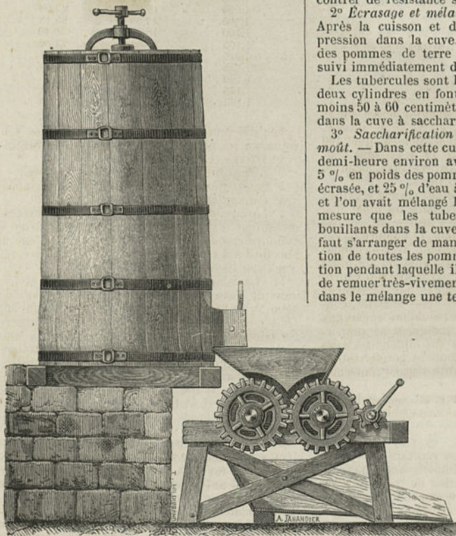
Fig. 10. Appareil pour la cuisson des pommes de terre.
