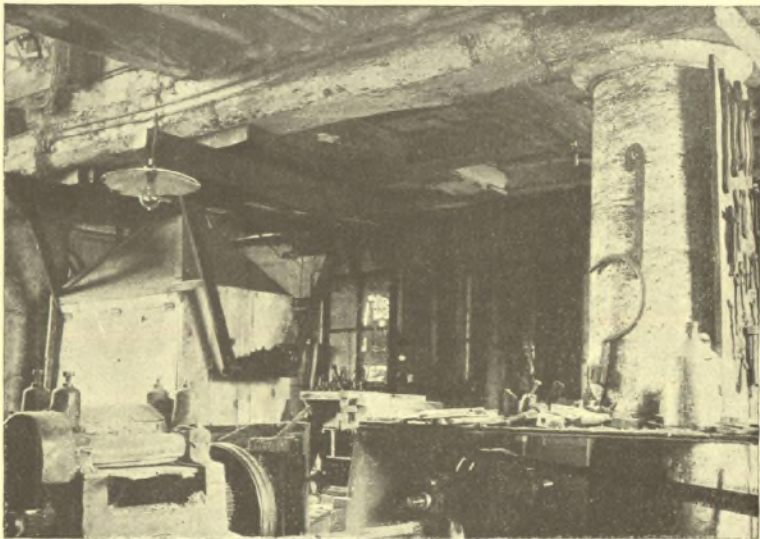
FIG. 32. — Intérieur du menuisier de Saint-Denis : raboteuse, scies diverses; au fond guérite vitrée contenant sa dynamo pour son éclairage; lampe au plafond.
