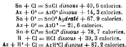
Quel que soit le degré de concentration des liqueurs, il ne se forme jamais d'ammoniaque ; il en est tout autrement quand on ajoute de l'acide chlorhydrique au chlorure d'étain avant de le traiter par l'acide azotique ; avec équivalents égaux d'acide chlorhydrique et de protochlorure d'étain, il se produit une combinaison cristalline de bichlorure d'étain et de sel ammoniac :
