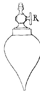
FIG. 28. — Ampoule de M. A. Witz pour la préparation du mélange combustible introduit dans le calorimètre.
