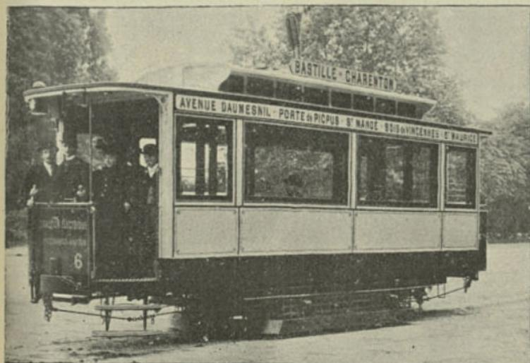
Fig. 56. — Tramway à traction mixte par fil aérien et trolley et par caniveau souterrain.
