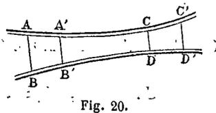
Puisque nous avons supposé le régime permanent établi, les masses comprises dans les volumes ABA'B', CDC'D' ont la même valeur  $dm$ . Si nous désignons par  $\varphi_0$  la vitesse du fluide en AB et par  $\varphi_1$  sa valeur en CD, la distance des plans AB et A'B' est  $\varphi_0 dt$ , celle des plans CD et C'D' est  $\varphi_1 dt$ . En appelant  $\omega_0$  et  $\omega_1$  les surfaces des sections AB et CD nous avons donc pour les volumes ABA'B', CDC'D',
