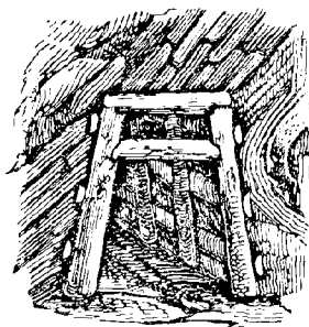
Fig. 61. Boisage renforcé contre des poussées latérales.
