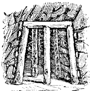
Fig. 60. Boisage renforcé dans les galeries larges.
