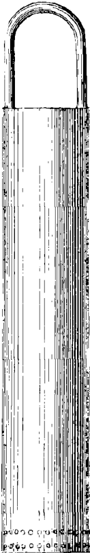
Fig. 21. Tarière à corde avec soupape à boulet.
