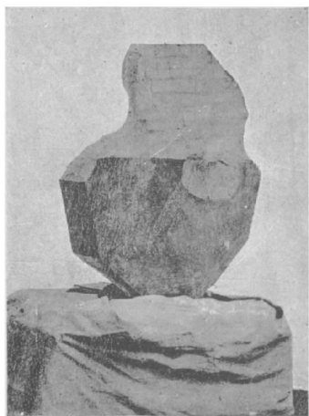
Fig. 68. — Bloc de crown après l'enlèvement à la meule des parties défectueuses.
